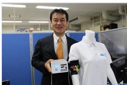
LTモニタは計測器と腕などに巻き付けるセンサーで構成する(武居教授)
